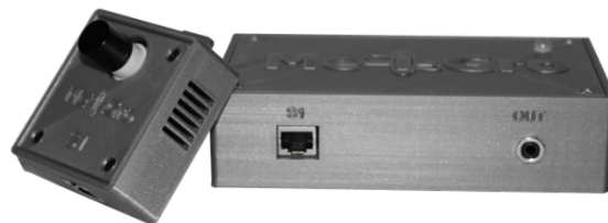
Abbildung 2: Luftqualitätssensor Modul (links) mit dem Raumklimagenerator (rechts).
