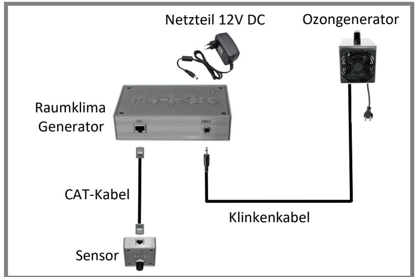
**Abbildung 1:** Verdrahtung der einzelnen Komponenten.
